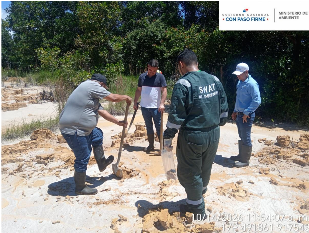
Tina de relave A, sin paredes de contención y sedimentos expuestos a la erosión.
